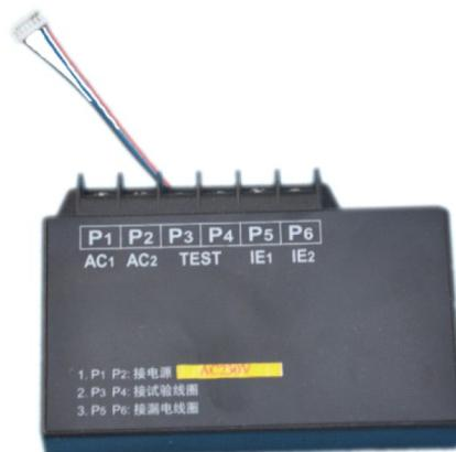
外置漏电模块与带漏电机型控制器配套使用，实现漏电功能。
