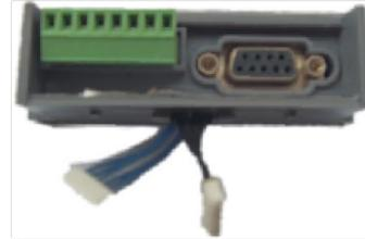
RS485 隔离转换，在控制器通讯组网或使用编程器时使用。
